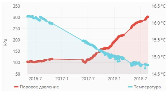
Рис. 25: Показания датчика порового давления (пьезометра) в скважине №5
